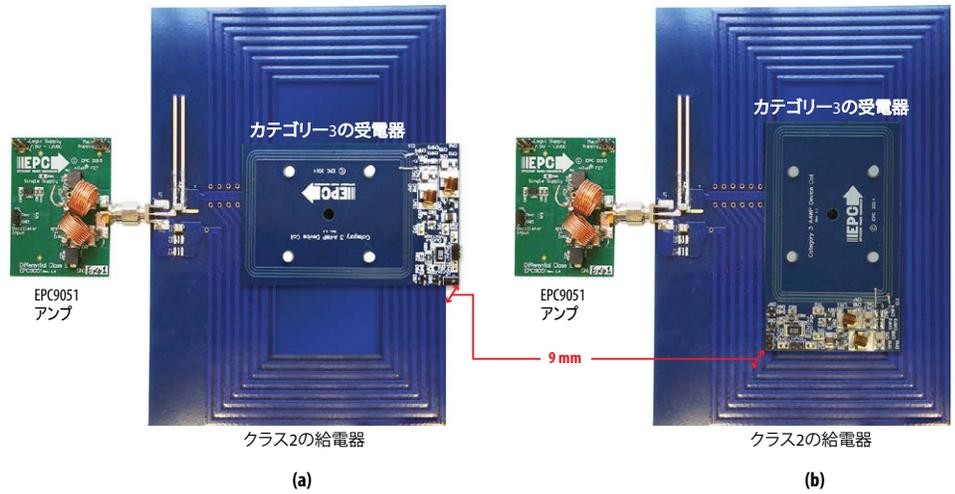
図10 ワイヤレス・パワー伝送用のシステム・テストのセットアップ：クラス2の給電コイルとカテゴリ-3の受電コイルを備えた差動E級アンプ (EPC9051)。受電コイルの2つの可能な向き。
